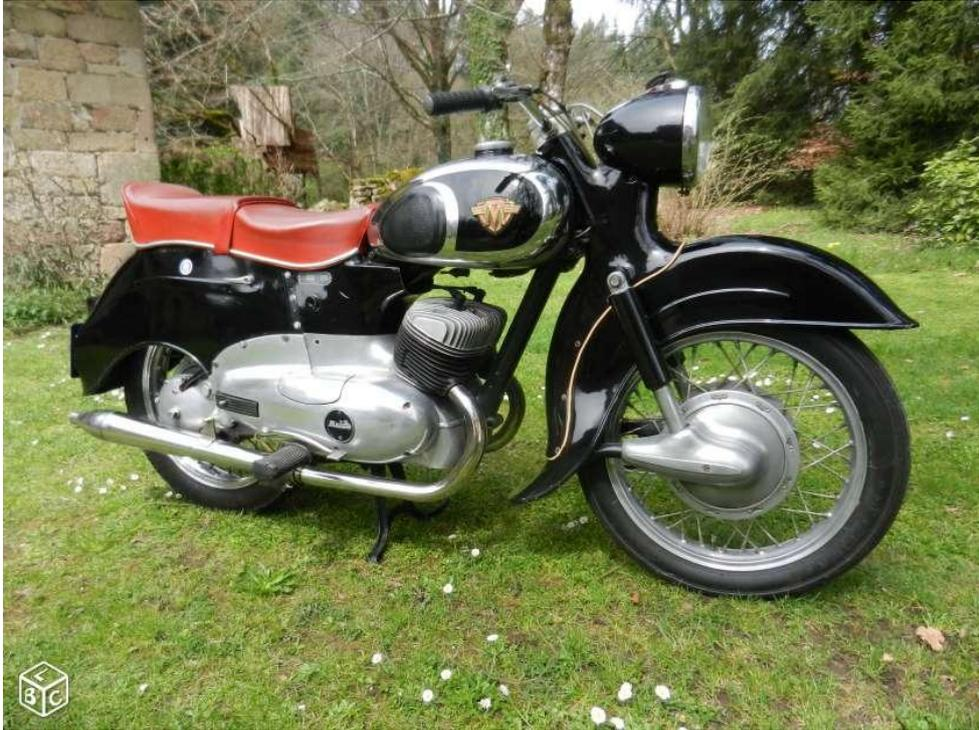
La Taifun est lancée en 350cc puis en 400cc. Elle dispose de deux carburateurs, sa transmission comporte une roue libre en décélération et un embrayage automatique.
