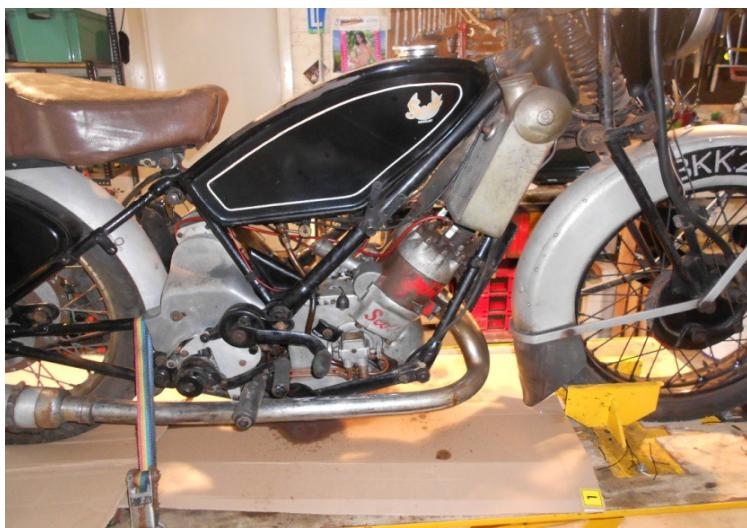
Le ressort de rappel du kick est mort. Qu'à cela ne tienne, un coup ou deux coups le moteur n'est pas calé c'est déjà ça, mais le véhicule est vraiment dans son jus, couche de graisse, poussière, selle biplace type banquette avec attaches cassées. Le démontage me prendra presque un an en prenant des photos et des notes de chaque composant démonté.
