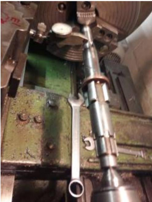
La difficulté principale de l'usinage du nouveau moyeu résidait dans l'exécution du cône à la bonne distance. Je ne dispose pas d'une machine à mesurer pour connaître l'angle exact de ce cône. Quand bien même aurais-je eu accès à un tel équipement, la tourelle de mon tour n'est pas équipée de lecture digitale.
