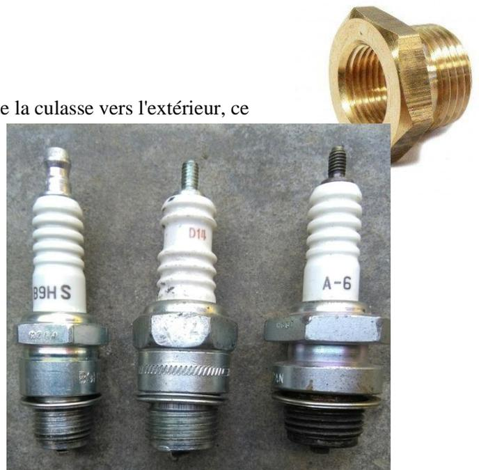
En plus du diamètre (18 ou 14 mm) et de la longueur de la partie filetée (courte 1/2" ou longue 3/4") les bougies diffèrent par la taille de la partie hexagonale sur laquelle vient se placer la clé à bougies.
