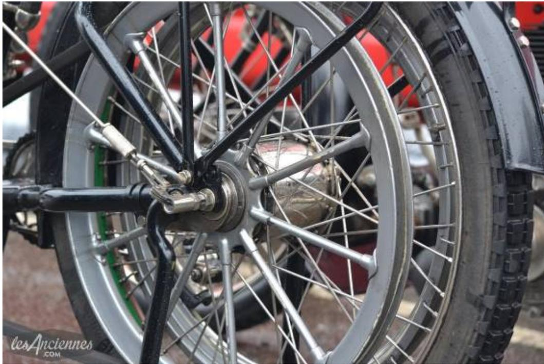
Lorsque le moteur fonctionnait avec le moyeu en position débrayée, la roue 'à bâtons' tournait sans entraîner celle de la moto.
