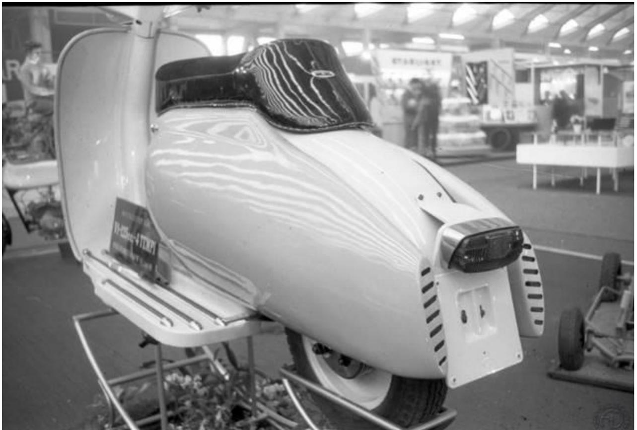
Pour favoriser la circulation d'air les flancs latéraux sont dotés d'évents d'entrée et de sortie d'air. Notez la selle en skai lisse et brillant.
